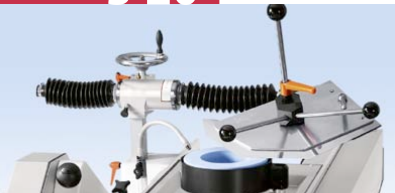
Reparaturschleifen auf Topf-Schleifscheibe
