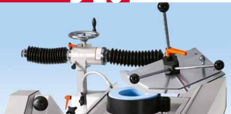
Affûtage d'un cutter (fortement abîmé) sur la meule boisseau
