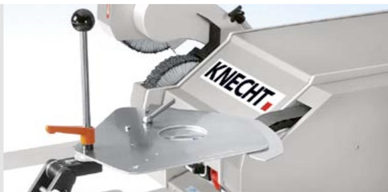
Заточка на влажной абразивной ленте
