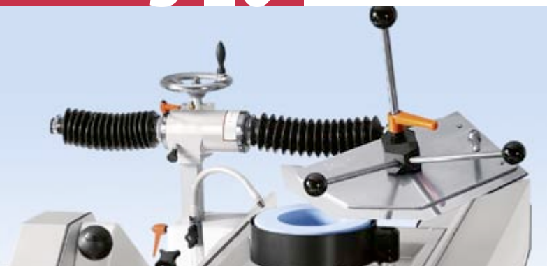
Ремонтная заточка на чашечном шлифовальном круге
