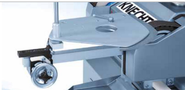
HV 261 – uniwersalny moduł dla taśm szlifierskich dla noży sierpowych kutrów
