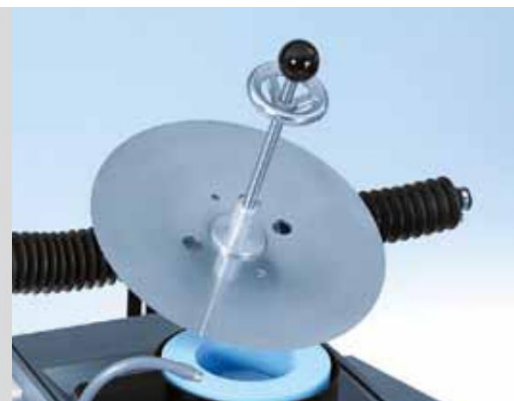
Noże okrągłe (średnica 80-480 mm) ostrzone przy życiu ostrzacza czaszowego
